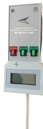
Рис. 1. Измеритель параметров электромагнитного и магнитного полей В-метр-АТ-002
